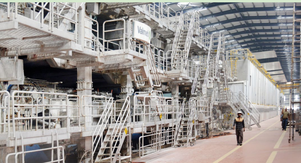
A máquina de cartão MC 1 da ITC Limited produz cartão dobrável para caixas de alta qualidade em sua planta Bhadrachalam, na Índia.
