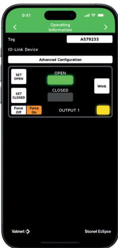
機器のタグ情報、アドレスを変更し、電磁弁を強制的にオンまたはオフにし、機器をウィンクさせ、バルブのしきい値を設定する。
