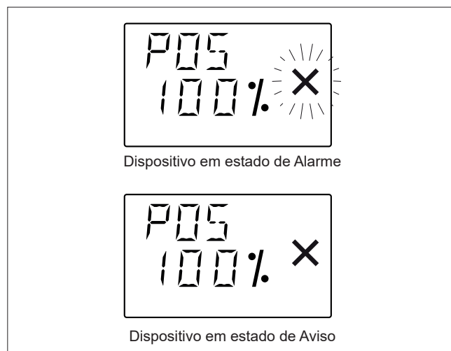
Fig. 21 Estados de Alarme e Aviso
